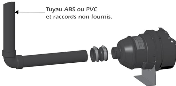
**7 BRANCHEMENT DE LA TURBINE À DISTANCE - ÉLECTRIQUE (THERMOMASSEUR®)**
