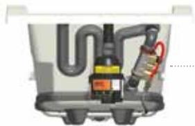
Le système Geysair est installé dans le conduit d'air, entre la baignoire et les circuits de protection de retour d'eau. Il est composé d'un filtre, de régulateurs de débit et de température, d'une électrovalve et d'un élément chauffant.
